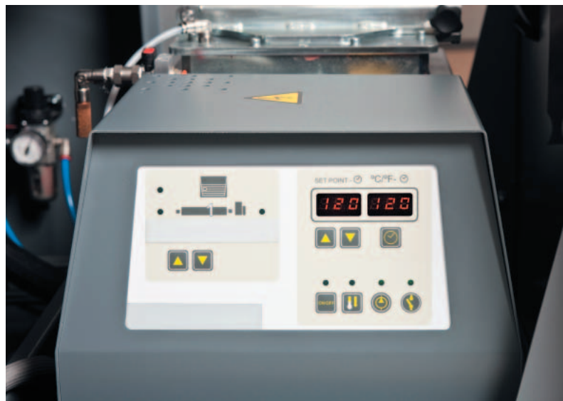
Wbudowany zbiornik kleju PUR oraz jednostka topienia kleju
